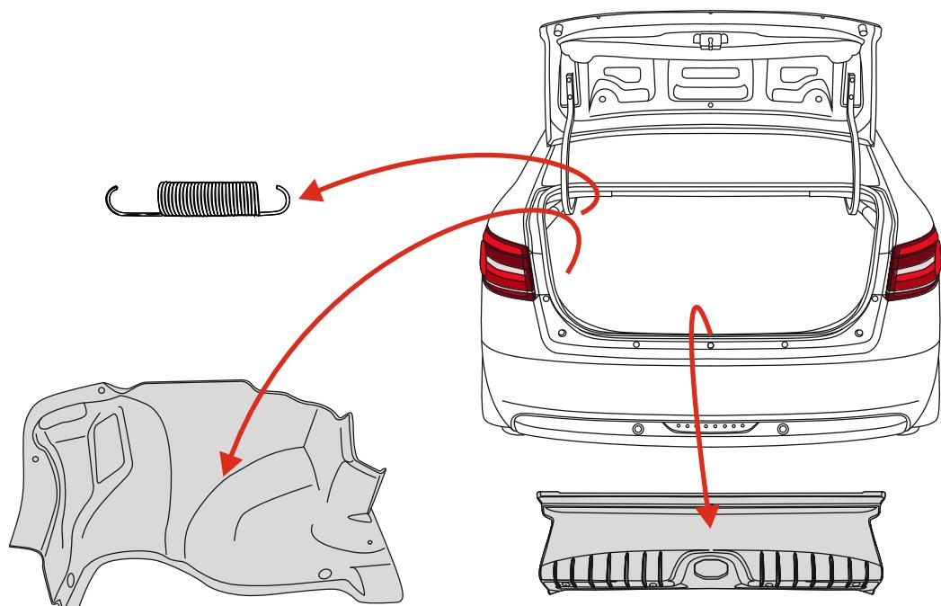
Элементы обшивки, которые рекомендуем демонтировать перед установкой комплекта проводки.
