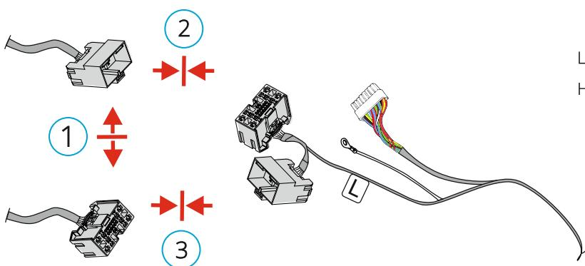
Соедините колодки **24 pin** до щелчка, в порядке, указанном на рисунке, надежно закрепите.
