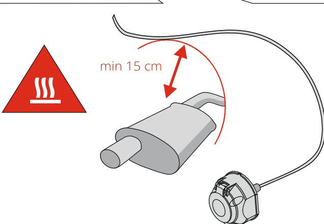
Монтаж кабеля производите на расстоянии более 15 см от выхлопной трубы.
